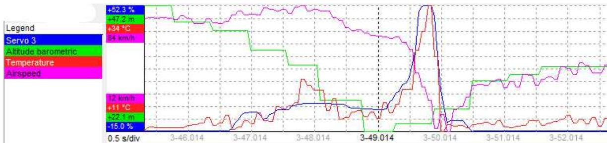
Abb. 5-8 Messwertediagramm Rückenflug und Aufrichten mit einem Looping (Screenshot „Weatronic GigaControl“) Zeitausschnitt: 3min45s ≤ Δt ≤ 3min53s; Modell im Rückenflug 3min46s ≤ Δt ≤ 3min50s
