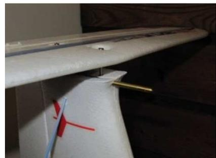
Abb. 4-1 Staurohr zum Messen der Geschwindigkeit des Modells zur Luft; rechts: eingebaut im Seitenleitwerk des „Arcus Sport“ direkt unter dem Höhenruder
