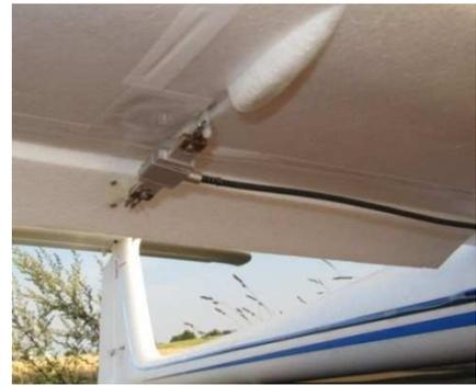
Abb. 4-2 Das Modell "Robbe Arcus Sport" und der Kraftsensor im Gestänge der rechten Landeklappe
