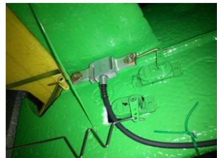
Abb. 4-3 Das Modell "Multiplex Parkmaster 3D" und die Position des Kraftsensors in der Anlenkung des Höhenruders
