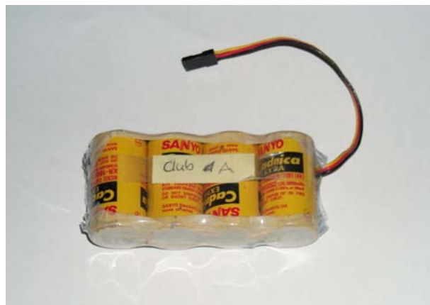
BILD 2: Im Modellflugclub Rossendorf e.V. verwendeter Empfängerakku für Segelflugmodelle. Die Kapazität beträgt 1,8 Ah; Typ KR-1900SCE; Sanyo, Bauform SC.
