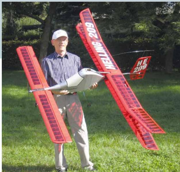
Für Luftfahrzeuge bis rund 200 km/h Reise ersetzt der hellingsche Doppel-Hubflügel sowohl den Propeller wie auch die Tragfläche. Dabei benötigt er für die gleiche Flugleistung nur die Hälfte der Energie. Flügel-Das Magazin hat Karl-Heinz Helling in Dresden besucht, wo der Ingenieur seit über zwei Jahrzehnten auf dem Gebiet der Vortriebsoptimierung mit Hilfe von Modellen forscht und entwickelt. Mit seinem neunten Modell, dem HE209, hat er nun den Durchbruch geschafft.
