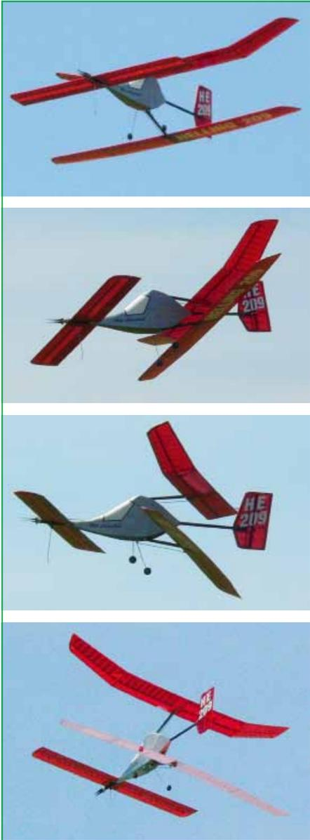
**Doppel-Hubflügel HE209:** Die vier Aufnahmen eines Vorbeifluges zeigen die unterschiedlichen Hub- und Einstellwinkelstellungen sowie den zusammengeklappten, ruhenden Propeller vor dem Entenflügel.
