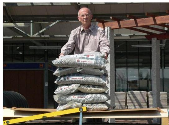
Abb. 7.4: Belastungstest der Tragfläche
