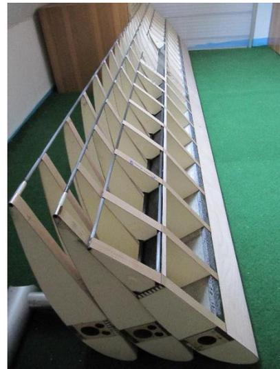
Abb. 7.2: Hubflügel und Entenleitwerk im Rohbau
