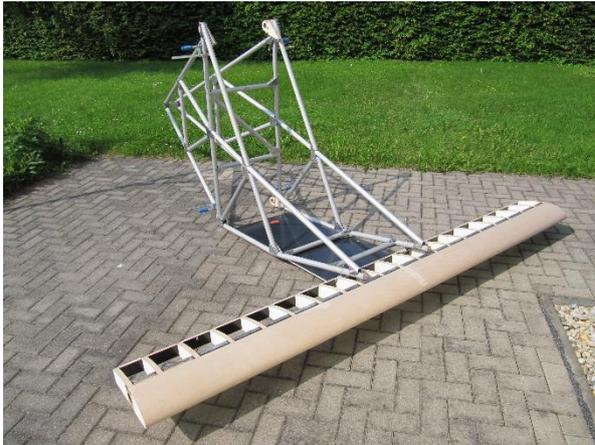
Abb. 7.5: Gitterrohrrahmen des Rumpfes mit montiertem Entenflügel
