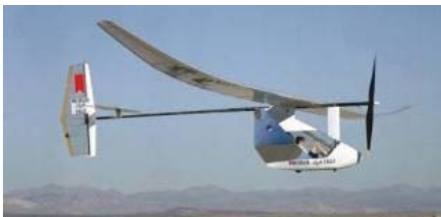
BILD 1: Der am MIT gebaute Daedalus88 fliegt 1988 muskelkraftgetrieben 115km über die Ägäis
