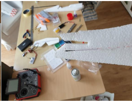
Servo für Höhe (evtl zusätzlich Seite einkleben) und Bowdenzug CFK Stab ablängen (alternativ 0.8mm Federstahl)
