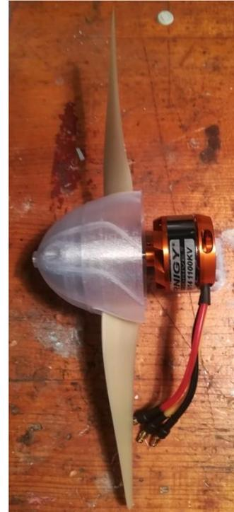
Nun ist aus den vorhanden 5 Größen die passende Motoraufhängung zu finden und mit geeigneten Schrauben am Motor anzubringen. Die Bohrungen passen exakt zu Motorrückseite und berücksichtigen bereits den Seitenzug.
