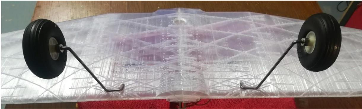
**Achtung:** zum Abschluß bitte die **Lagerbereiche in der Tragfläche mit Sekundenkleber verfüllen**.
