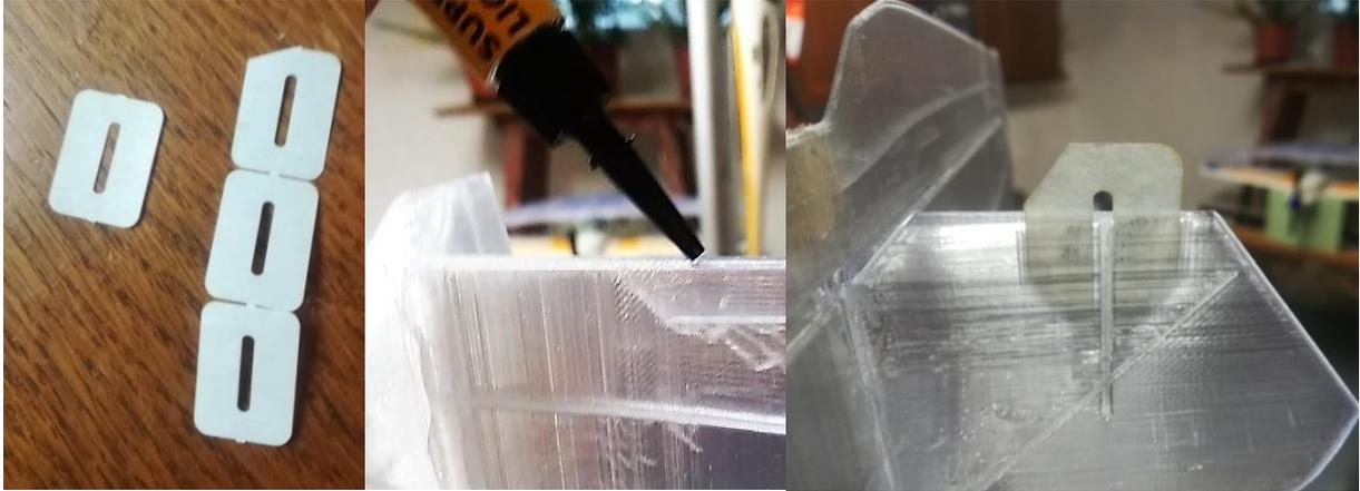
Als Scharniere für die Ruderanlenkung benutze ich biegsame Blättchen. Sie passen exzellent in die dafür vorgesehenen Aussparungen. Bevor ich diese einpasse – mit dünnflüssigem Sekundenkleber zu etwa 50% füllen und danach das Scharnier einbringen und kurz ausrichten.
