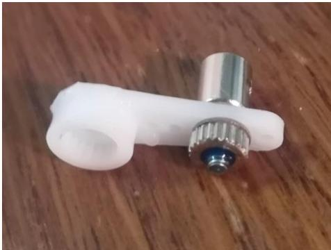
Als Verstellmöglichkeit der Anlenkungen benutze ich die dargestellten Einzelteile. Am Höhen- und Seitenruder selbst erfolgt die Anlenkung wieder direkt – soweit möglich.
