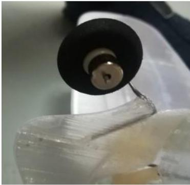
Auch für den Draht (ca.1.2mm) des Spornrades gibt es eine druckbare Vorlage zum Biegen. Danach ebenfalls viel Sekundenkleber zugeben und den Draht in die vorhandenen Öffnungen einkleben.
