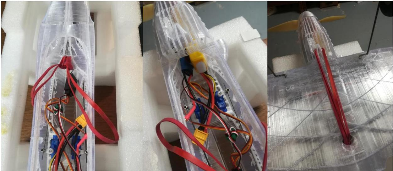
Wir testen nun die sichere Verbindung der Flächen am Rumpf durch Spannen der Gummis.
