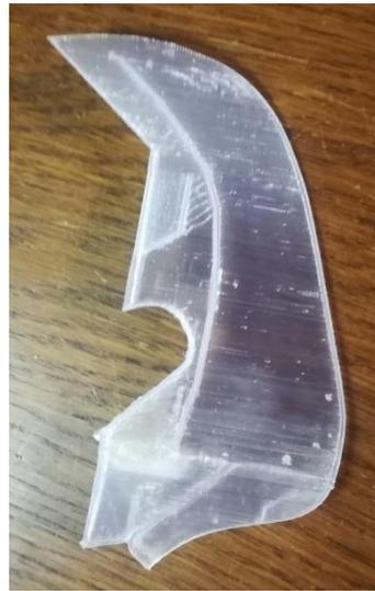
Am Seitenruder ist noch etwas Material (halbmondartige Aussparung) zu entfernen – ähnlich wie beim Rumpf am besten mit einem heißen Lötkolben:
