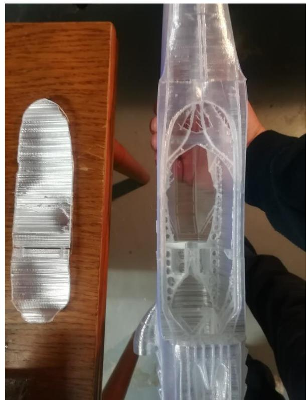
Zum Abschluss noch an der Unterseite, wo später die Tragfläche eingehangen wird, den Zugang zum Innenraum – am besten mit einem LötKolben – „freischneiden“ und fertig ist schon mal der Rumpf.
