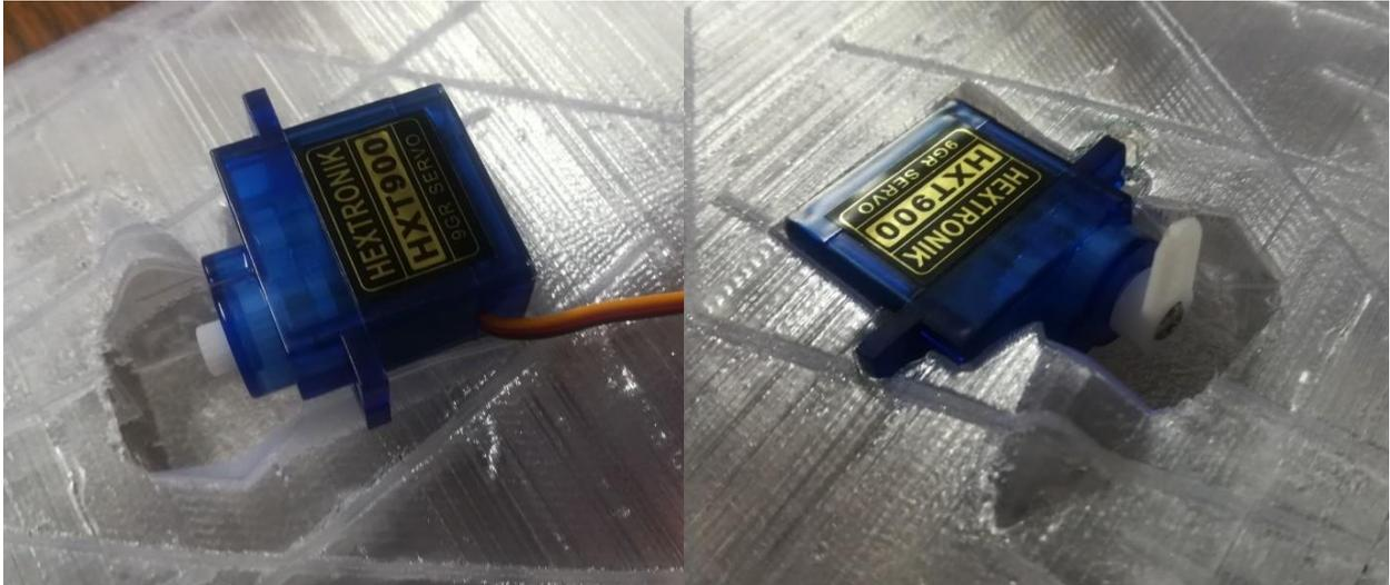
Nun wird die Servoverlängerung durch den vorhandenen Kanal gezogen und der Servo in den Schacht eingedrückt – jedoch nicht fixiert. Die Anlenkungsdrähte der Querruder wurden von mir direkt angebracht.
