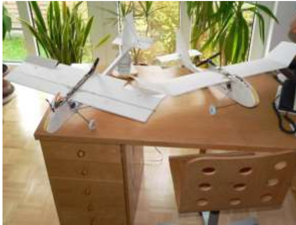
Bild 7 und 8 / pu_hd2 rechts, pu_hd3 mit QR links / Leitwerksträger aus 3mm Depron
