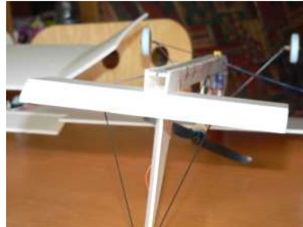
Bild 7 und 8 / pu_hd2 rechts, pu_hd3 mit QR links / Leitwerksträger aus 3mm Depron
