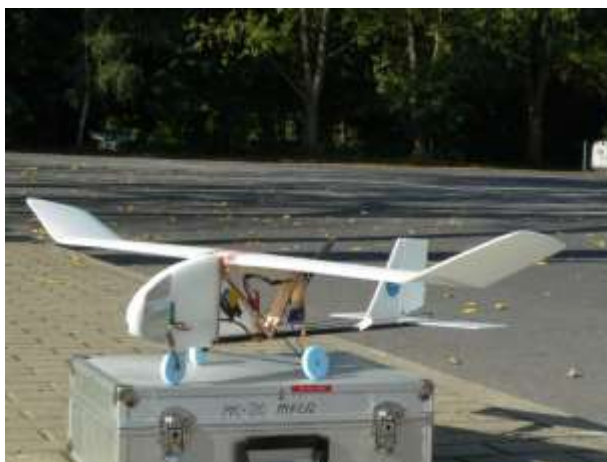
Bild 6 Das Urmodell pusher_hd1 (hd steht für Hochdecker) wurde ab Mai 2011 eingesetzt. Es flog später ohne Fahrwerk und war nach zwei Schuljahren verschlissen
