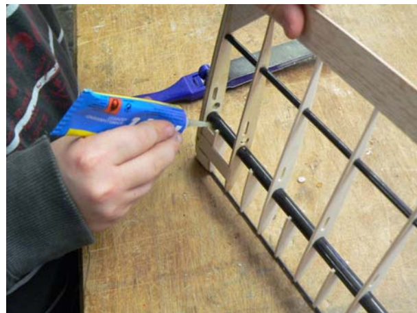
Hier noch Restleimungen an der Tragflügelwurzel
