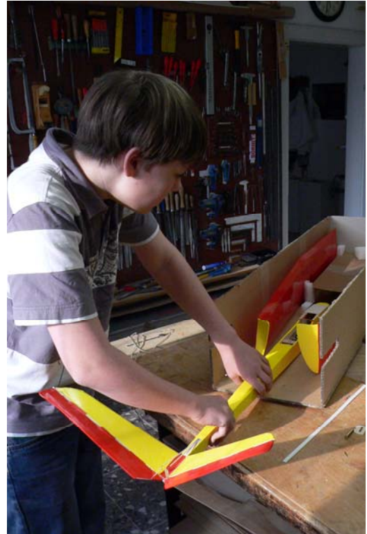
Die Seitenwände des Rumpf-Tunnels bestehen aus glatter Pappe, um ein Festhaken des Propellers beim Rausziehen zu verhindern. Auch die Flügel bekommen noch einen (weißen) Deckel drüber
