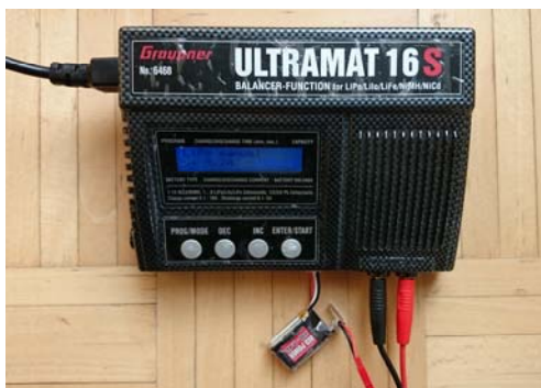
Bild 5.23 Moderne Ladegeräte bieten die für LiPo und NiMH erforderlichen Ladeverfahren a) das Ultramat 16S lädt/entlädt außer NiCd, b) im Delta-Peak-Verfahren schaltet das Gerät NiMH und LiPo vier weitere Li-Typen. Die Daten bei einem Spannungsrückgang um \Delta U = 20\text{mV} können am PC ausgelesen werden. den Ladestrom des NiMH-Akkus sprunghaft ab.
