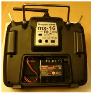
Bild 5.22: Stromversorgung des Graupner HoTT mx16 Senders mit NiMH-Akku, 4,8V; 2000mAh
