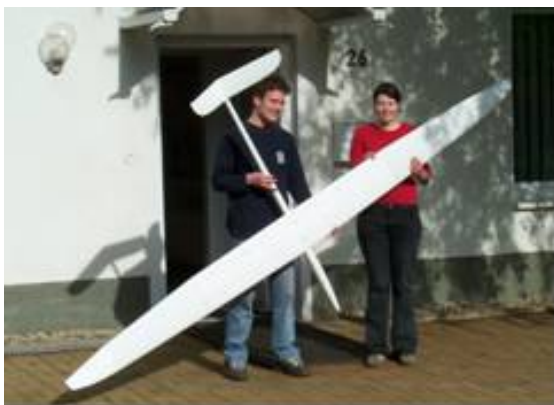
Bild 6.7a): Unter maßgeblicher Beteiligung von mfcR-Jugendlichen entworfenes und gebautes F3J-Modell RS3; m = 2,4\text{kg} , A_F = 68\text{dm}^2 [JW04]
