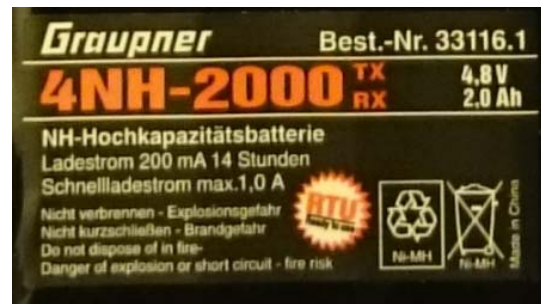
Bild 5.22: Stromversorgung des Graupner HoTT mx16 Senders mit NiMH-Akku, 4,8V; 2000mAh
