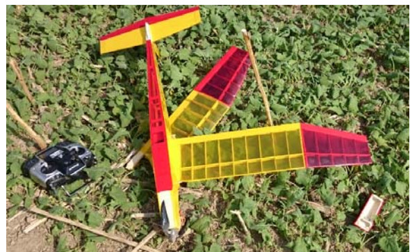
Bild 6.12 Ein falsch entworfener Doppel-T-Holm aus Kiefernleisten in einem Baukastenmodell a) Gurt oben 3x3, Gurt unten 3x8 stehend. Der schwächere Gurt hätte unten, der stärkere Gurt – flach eingebaut – oben hingehört. b) Das Modell wurde im mäßig steilen Bahnneigungsflug aus einer Thermikblase heraus gesteuert. Der Flügel zerbrach beim Abfangen.
