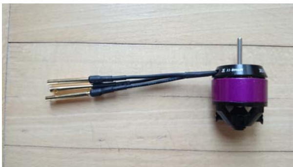
Bild: 5.27 Brushless-Außenläufer-Motor A10-13L und die vom Hersteller angegebenen technischen Daten [Hack19]. Hinweis: ein bürstenloser Motor braucht drei Anschlüsse.
