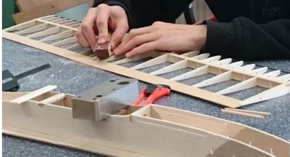
Bild 6.11a) Am Flügel-Rohbau werden die Aufbauhilfen an den Rippen weg geschliffen. Auch die Verstärkung zwischen den Holmgurten ist gut zu erkennen. b) Fast fertiges Modell Motorsegler Strolch
