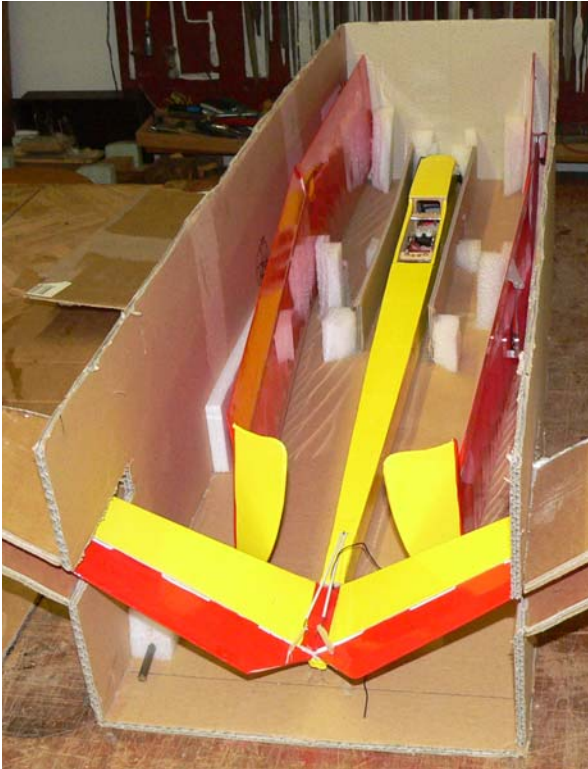
Die Seitenwände des Rumpf-Tunnels bestehen aus glatter Pappe, um ein Festhaken des Propellers beim Rausziehen zu verhindern. Auch die Flügel bekommen noch einen (weißen) Deckel drüber
