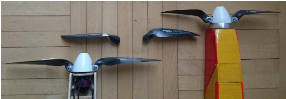
Bild 5.30: CFK-Propeller der Fa. Aeronaut, variierend in Durchmesser D und Steigung H . Von links: D \times H = 9'' \times 5'' ; 8'' \times 4'' ; 7'' \times 4''
