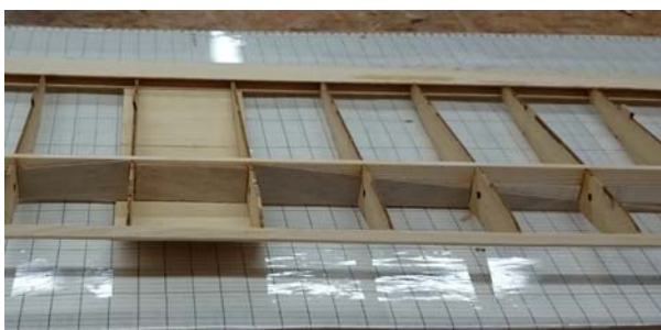
Bild 6.13 Stege durchgängig, beidseitige Holmbeplankung im Mittelbereich, linear abnehmend: Biegespannungs-Sprünge werden so minimiert
